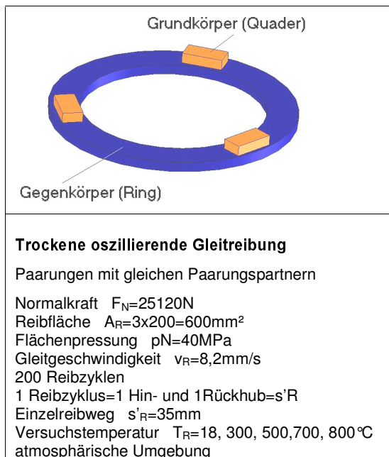
Bild 3: Prüfmethode (Siebel-Kehl-Prinzip) und Versuchsbedingungen des Hochlastprüfstandes
